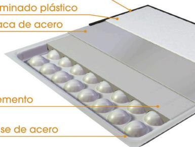
DISEÑADO ESPECIALMENTE PARA SALA DE ORDENADORES Y SALA LIMPIA
